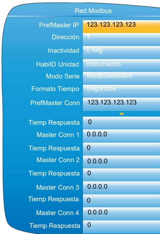
Figura 84 Menú de configuración del Modbus TCP
