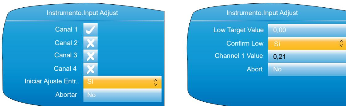
Figura 73 Procedimiento de ajuste de canal (2)
