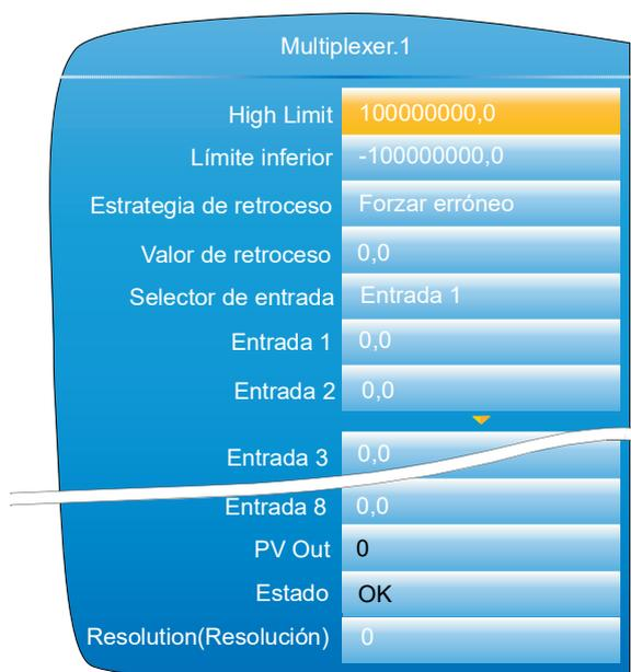
Figura 148 Configuración del bloque del multiplexor
