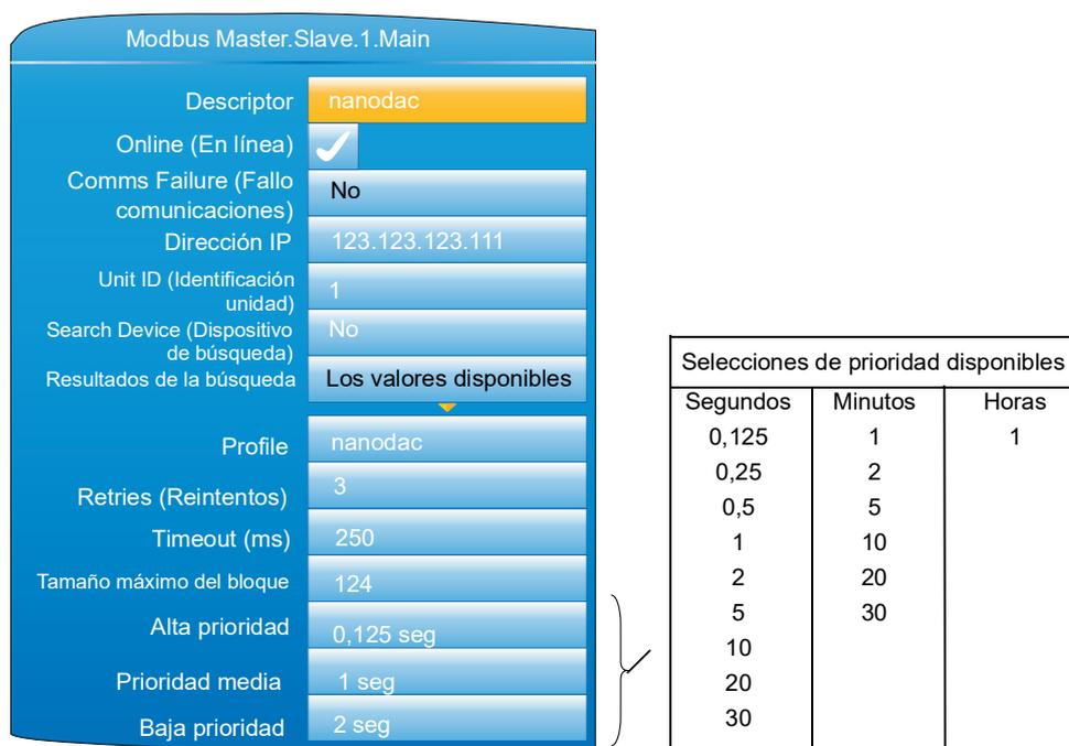
Figura 123 Configuración Modbus Maestro Esclavo 1 (Esclavo 2 similar)
