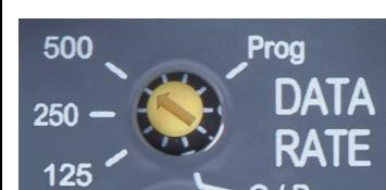
Anmerkung: Wählen Sie die „Prog“-Position, um Firmware Upgrades zu ermöglichen. Gegebenenfalls müssen Sie das Gerät neu starten.
