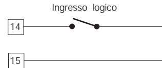
Fig.7 COLLEGAMENTO DELL'INGRESSO LOGICO
