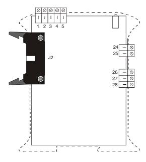
Fig. 16 - COMMON I/O UNIT TERMINAL BLOCK
