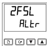
Le paramètre sélectionné est Alarme 2, pleine échelle basse
