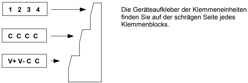
Abbildung 3-2: Geräteaufkleber einer Klemmeneinheit (Beispiel)
