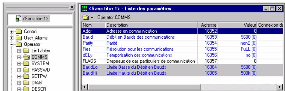
Figure 6-2: Paramètres de communications Modbus (niveau Configuration)
