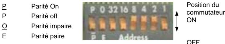
Figure 2-8 : commutateur d'adresses Modbus
