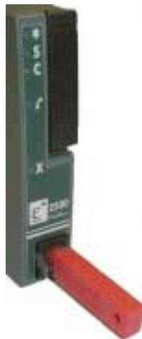
Figure 2-2 : clé de configuration représentée installée
