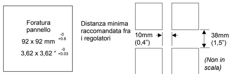
Figura 2-2:- Foratura pannello e distanze minime necessarie
