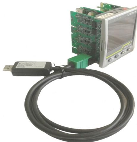
Der Vorteil dieser Verbindung liegt darin, dass das Gerät nicht angeschlossen sein muss, da der Clip die Versorgung für den internen Speicher des Anzeigers liefert.
