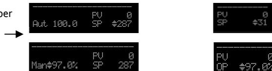
Se viene visualizzato il sinottico del ciclo 1, premere il tasto A/MAN per passare dalla modalità automatica a quella manuale del ciclo 1.
