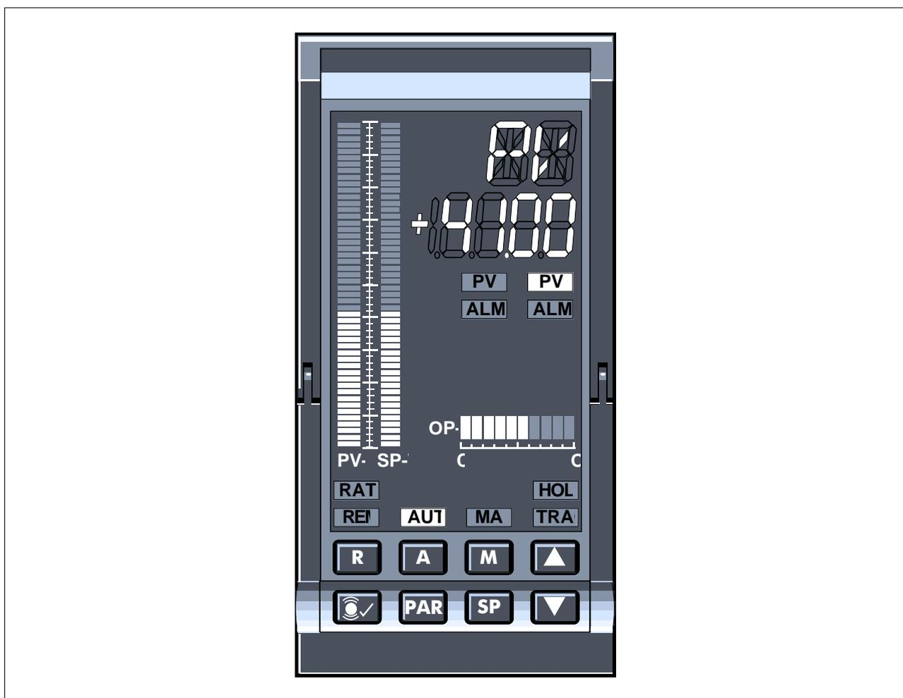
**Figura 1-1 Pannello Frontale del Regolatore di Processo**
