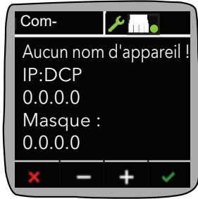
Figure 39 Écran « Comms » de l'EPack sortant de l'usine (Nom de l'appareil = « », Configuration IP = Nul).
