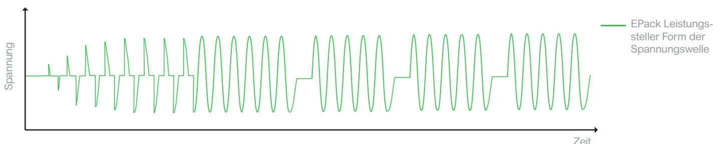
Der EPack-Leistungsregler schaltet in Abhängigkeit vom ohmschen Wert der Last automatisch vom Impulsgruppenbetrieb in den Phasenanschnittbetrieb um, z.B. während der thermischen Streßphase, wenn die Last also kalt ist.. Die fortschrittliche Anlaufunktion ermöglicht einen sanften Anlauf mit geringerer Belastung der Last.
