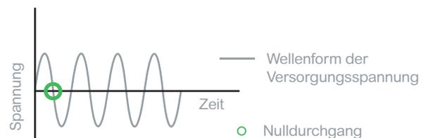
Der EPack-Leistungssteller kann einen Nulldurchgang auf der Spannungswellenform genau erkennen und ist in der Lage, den Thyristor in diesem Moment zu triggern. Dies führt zu weniger harmonischen Verzerrungen und RFI, zur Reduzierung der Gleichstromkomponente und zu einer präzisen Reaktion auf den Leistungsbedarf.
