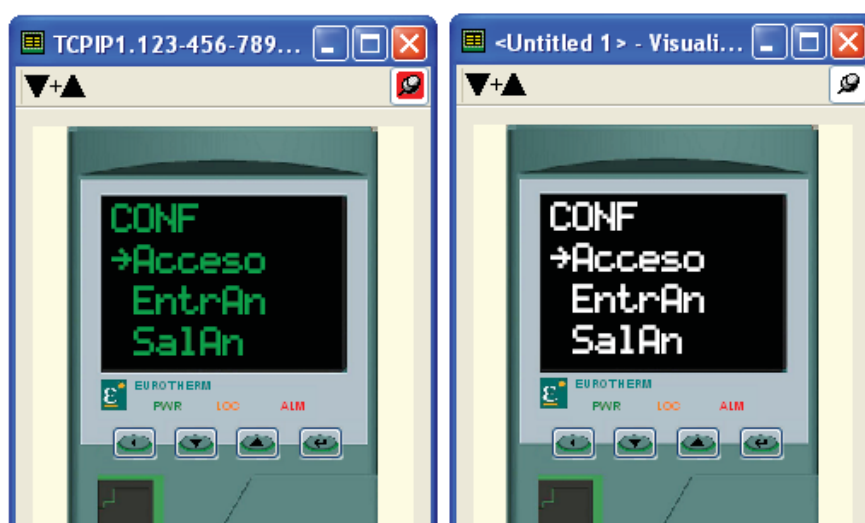
Figura 7.6 Visualización en línea (izquierda) y clon (derecha) del panel del dispositivo.
