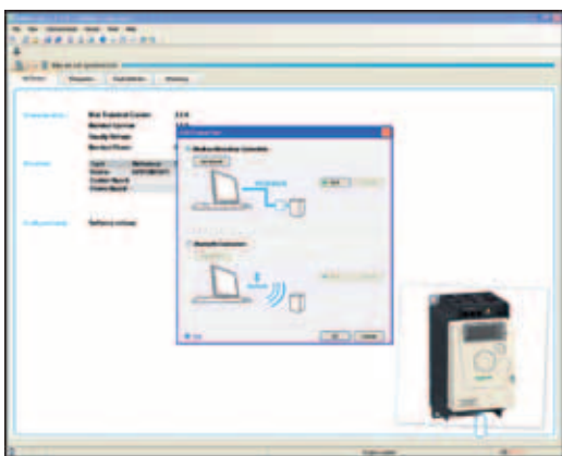
Ejemplo de conexión del software SoMove a un variador ATV 12
