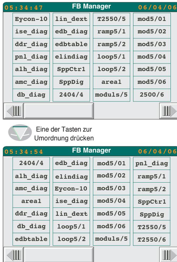
Abbildung 4.3.8d Alphanumerische Funktionsblockanordnung.
