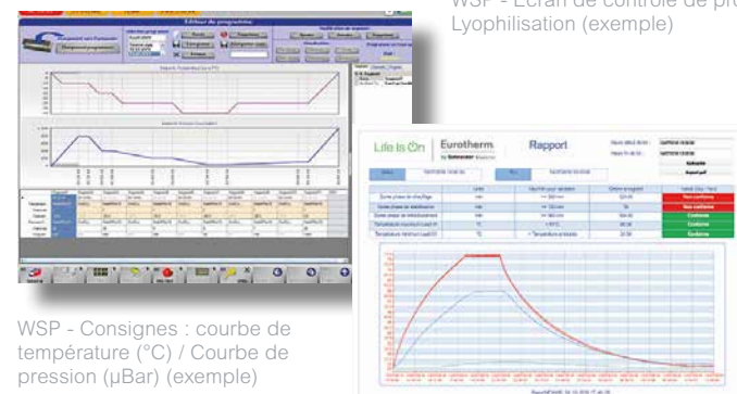
Eurotherm Dream Report. Analyse des phases de chaud/froid, de température et de consigne. (exemple)
