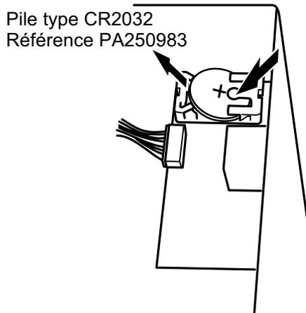
Figure B3.2a Remplacement de la pile (montage original)
