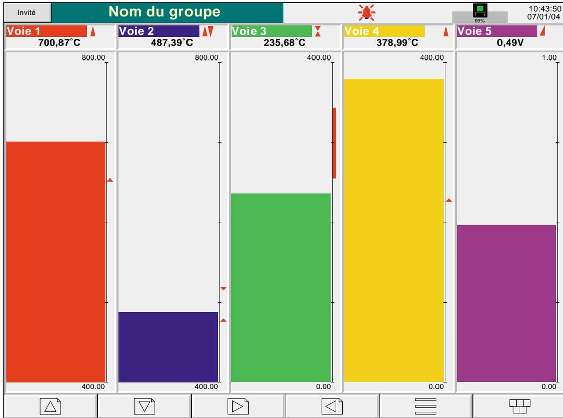
Figure 3.4.3a Mode barres-graphes verticaux (1 à 6 voies)
