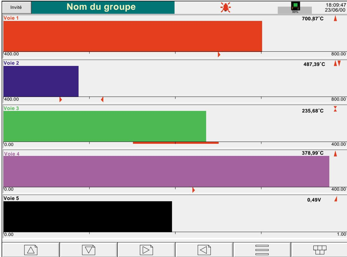
Figure 3.4.4a Mode barres-graphes horizontaux (1 à 12 voies)
