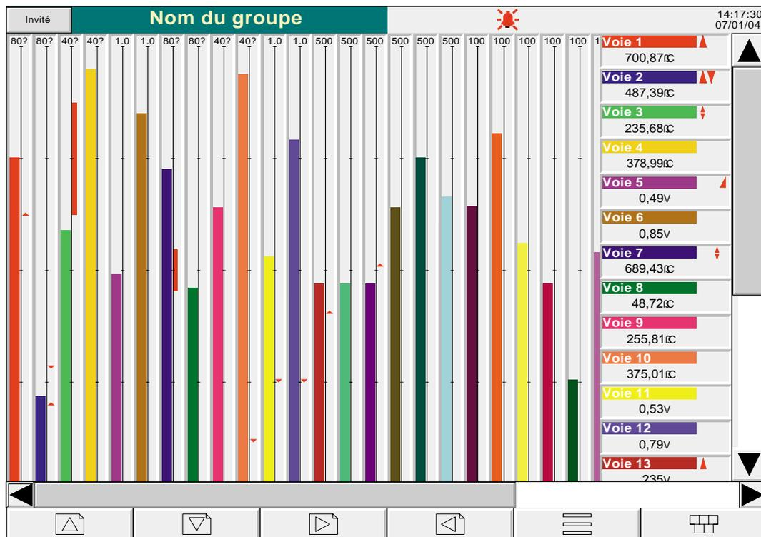
Figure 3.4.3b Mode barres-graphes verticaux (plus de 6 voies)
