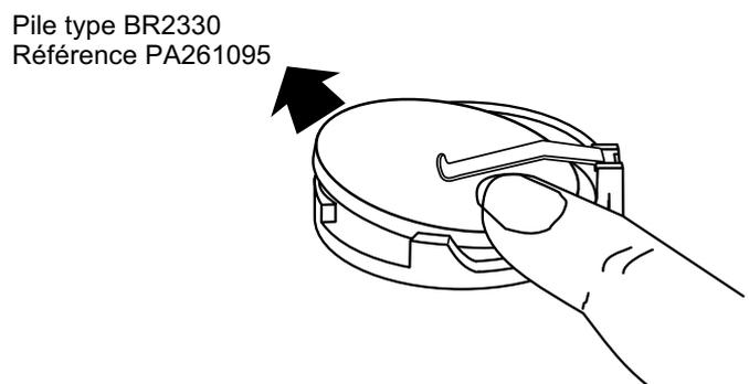
Figure B3.2b Remplacement de la pile (nouveau montage)
