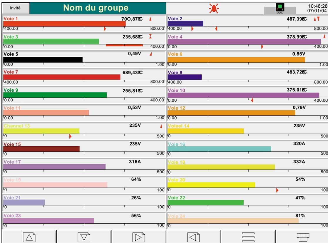
Figure 3.4.4b Mode barres-graphes horizontaux (plus de 12 voies)
