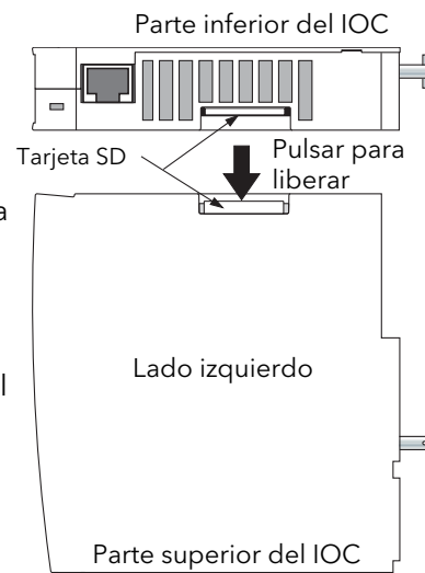
Figura 12.2.1a Sustitución de la tarjeta SD
