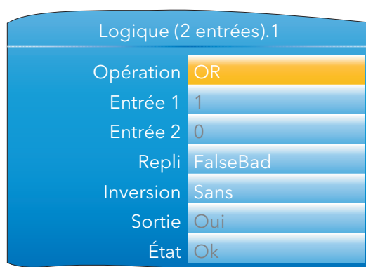
Figure 4.19 Configuration d'un bloc logique à deux entrées
