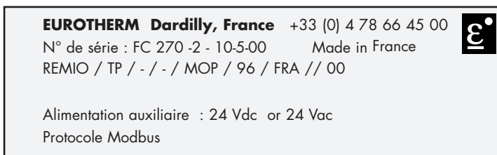
Figure 1-5 Exemple de l'étiquette d'identification du REMIO (correspond à l'exemple N°1 de codification)
