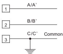
Fig. 12 - RS-485 WIRING
