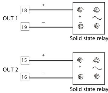
Fig. 11 – SSR DRIVE OUTPUT WIRING
