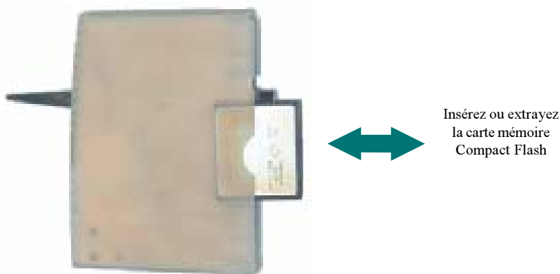
Figure 8.2.1 Remplacement de la carte mémoire Compact Flash
