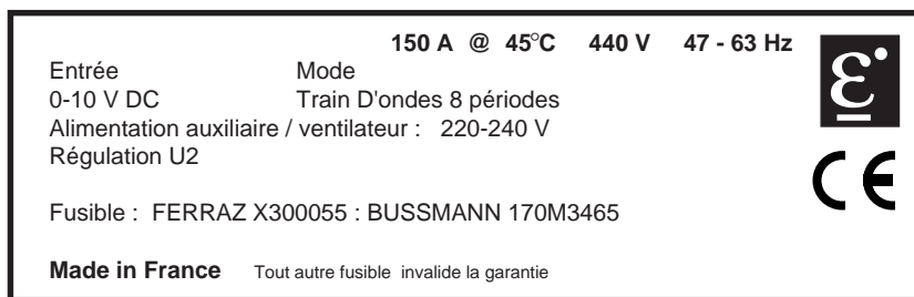
Figure 1.4 Exemple d'une étiquette de configuration du gradateur TC3000
