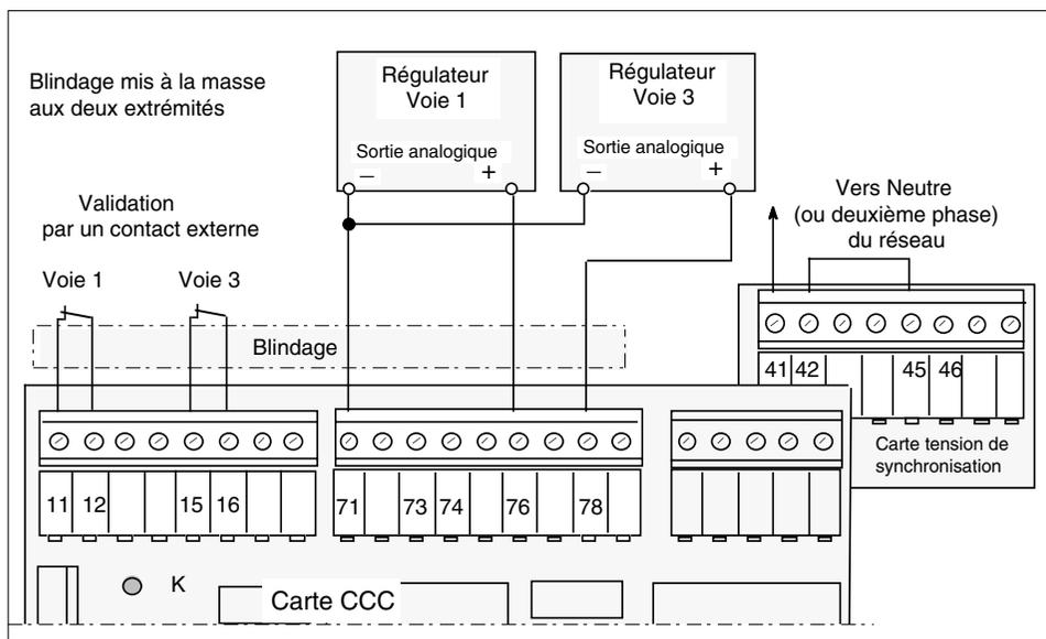
Figure 3-10 Exemple de branchement de signaux analogiques de voies 1 et 3 sans communication
