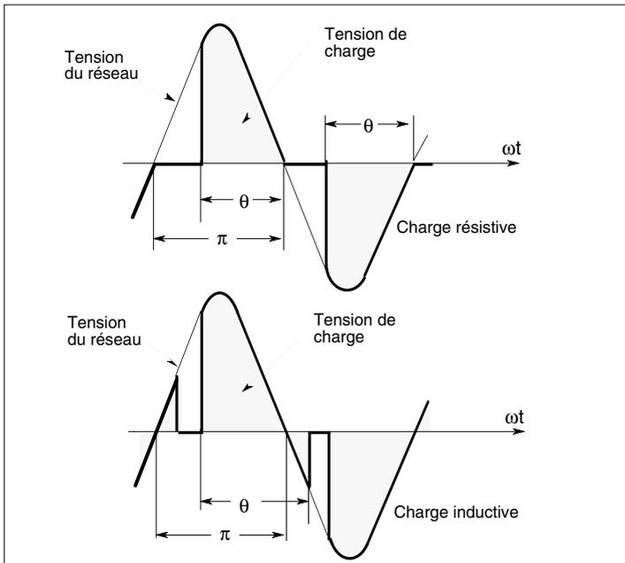
Figure 5-1 Tension de charge en mode de conduction «Angle de phase»
