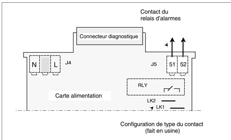
Figure 3-5 Raccordement du contact du relais d'alarmes (vue côté soudures)
