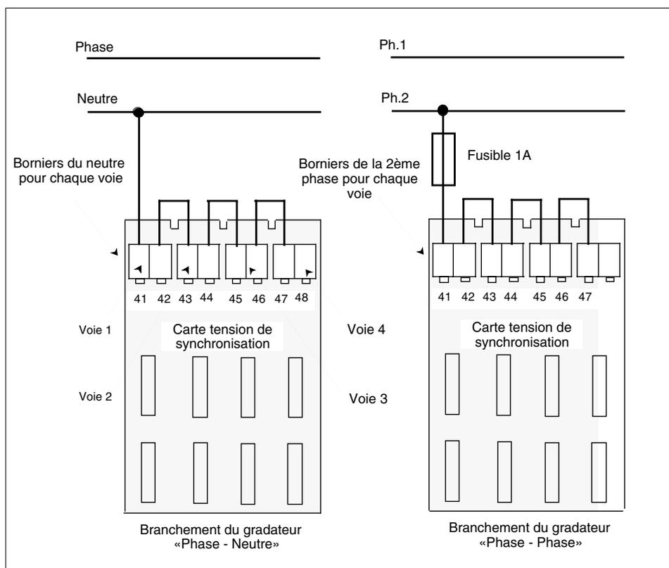
Figure 3-6 Raccordement de la carte de tension de synchronisation
