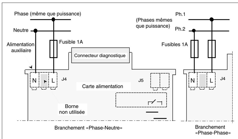
Figure 3-4 Borniers de l'alimentation de l'électronique et du contact d'alarmes (vue côté soudures)
