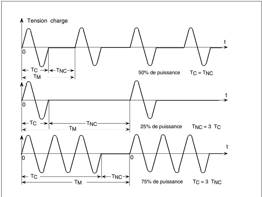
Figure 5-4 Conduction en mode «Syncopé»
