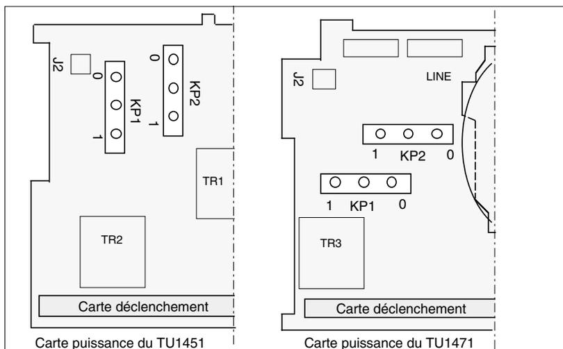
Figure 4-3 Emplacement des cavaliers de configuration sur la carte puissance
