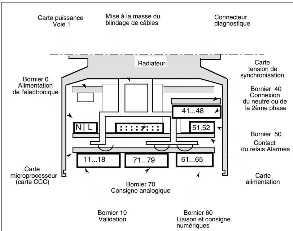
Figure 3-3 Disposition des borniers utilisateurs sur les cartes électroniques (vue de dessus)
