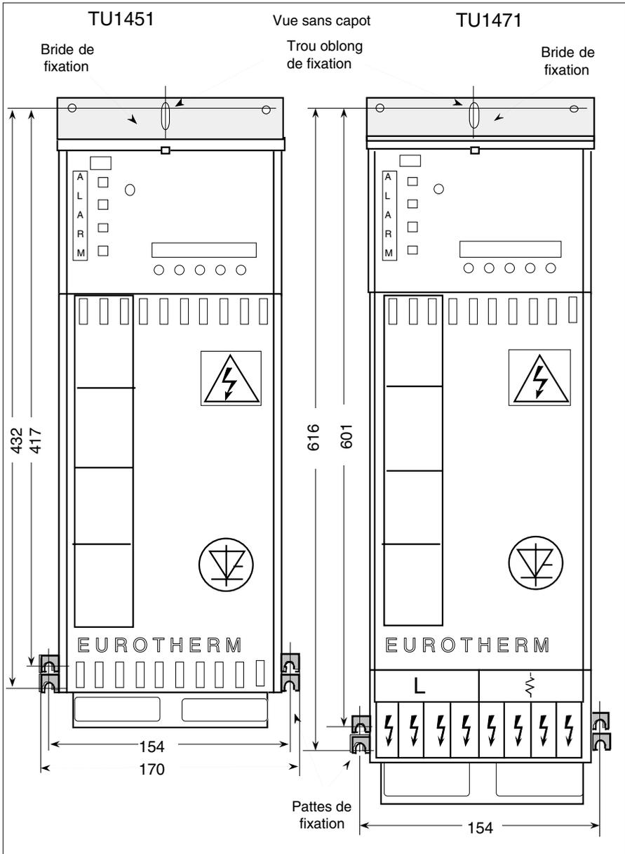
Figure 2-2 Points de fixation des gradateurs TU1451 et TU1471
