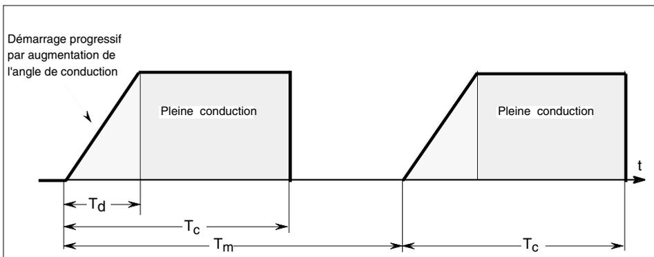
Figure 5-3 Démarrage progressifs en mode Train d'ondes
