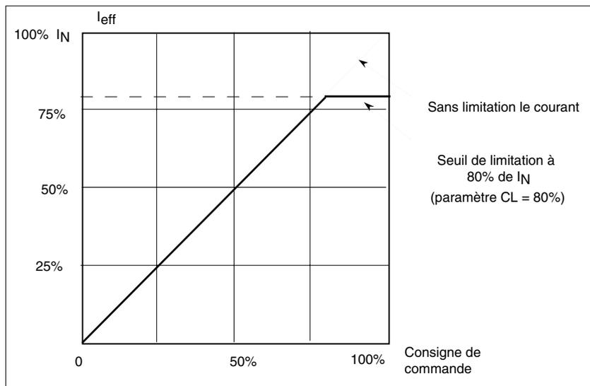
Figure 5-5 Exemple de limitation de courant
