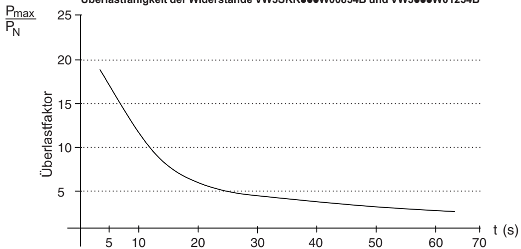
Überlastfähigkeit der Widerstände VW3SKR●●●W00854B und VW3●●●W01254B
