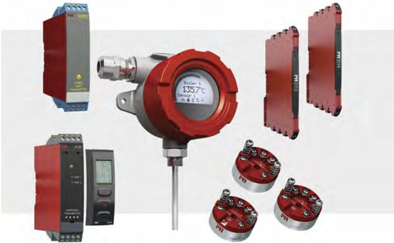
Unsere Temperatur-Messumformer wandeln das Sensor-signal in ein Ausgangssignal 4-20 mA-, 4-20 mA + HART-, 0-10 V und/oder ein Profibus PA-Signal. Die Messumformer können mit Universaleingang für Widerstandsthermometer oder auch Thermoelement geliefert werden. Lieferbar auch mit Zulassung ATEX EExi a/b.
