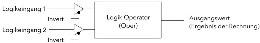
Abbildung 15-1: Logik Operator mit 2 Eingängen
