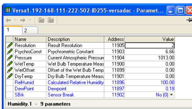
Abbildung 107 Konfiguration der Feuchteberechnung
