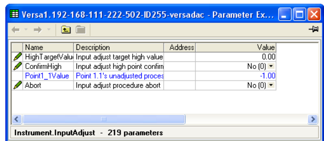
Abbildung 68 Eingangsjustage obere und untere Zielwerte
