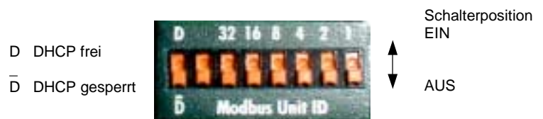
Abbildung 2-15: Ethernet Adressenwahlschalter
