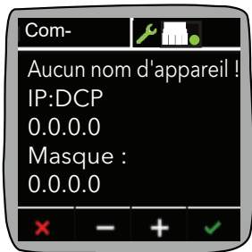
Figure 41 Écran « Comms » de l'E-Pack sortant de l'usine (Nom de l'appareil = « », Configuration IP = Nul).
