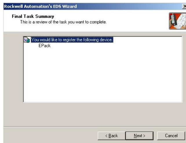
Figure 30 Assistant EDS, résumé d'installation
