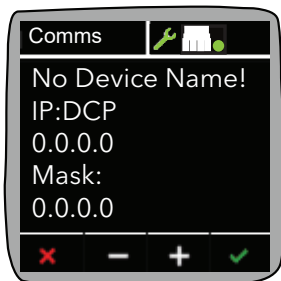
Figura 45 La schermata Comms (Comunicazioni) dell'Epack come viene fornito mostra (Nome dispositivo = "", Configurazione IP = Null).
