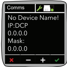
Figura 39 La schermata Comms (Comunicazioni) dell'Epack come viene fornito mostra (Nome dispositivo = "", Configurazione IP = Null).
