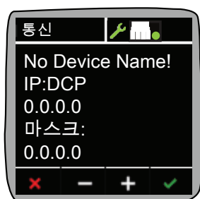
그림 39 '전송 상태'의 E-Pack '통신' 화면 디스플레이 (장치 이름 = "", IP 구성 = Null).
