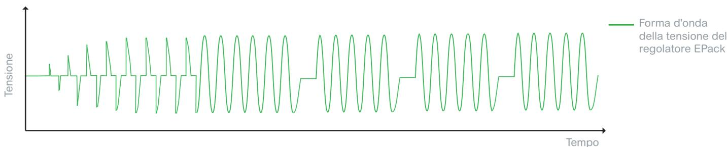
Il regolatore di potenza EPack passa automaticamente dalla modalità di innesco ad angolo di fase a quella a treno di impulsi in funzione del valore ohmico del carico, ad esempio in condizioni di carico freddo. La funzione avanzata di avviamento consente un avvio fluido, con meno sollecitazioni sul carico.
