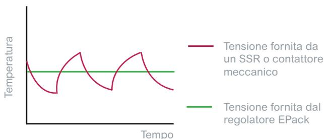
Rispetto agli SSR standard o ai contattori meccanici, il regolatore EPack controlla l'energia fornita all'elemento riscaldante, riducendo le fluttuazioni di temperatura e contribuendo a prolungare la vita operativa del riscaldatore.
