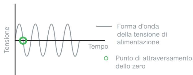
Il regolatore EPack è in grado di rilevare con precisione l'attraversamento dello zero della forma d'onda di tensione e di attivare contestualmente il tiristore. Ciò si traduce in una riduzione di distorsione armonica, RFI e componente cc e rende accurata la risposta alla domanda di potenza.
