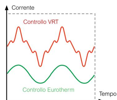
Con i VRT il riscaldatore assorbe più energia del necessario, ciò è dovuto alla generazione di armoniche in corrispondenza della maggior parte dei livelli di setpoint.
