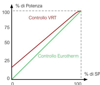
Il controllo di potenza digitale a SCR Eurotherm favorisce un controllo lineare su tutta l'ampiezza dell'uscita, a differenza dei VRT che, a livelli bassi di setpoint, forniscono un controllo instabile.
