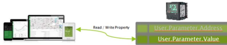
**Nota:** El valor de datos siempre se representará sobre BACnet como un punto flotante, incluso si los datos fuente internos son de un tipo diferente (por ej. booleano). Las cadenas no son accesibles utilizando este mecanismo.
